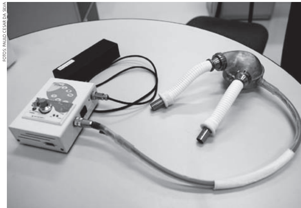
O modelo de coração artificial auxiliar e a bomba de sangue centrífuga implantável
